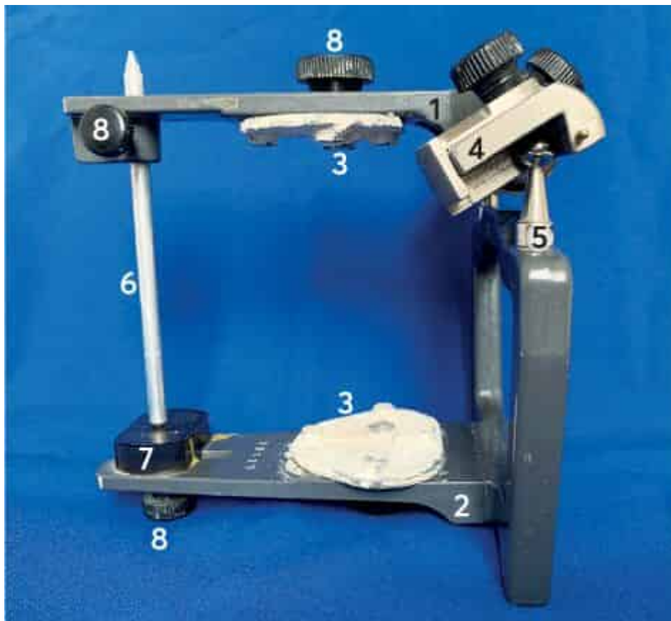
Figura 2 ASA: 1: Ramo superior; 2: ramo inferior; 3: placas de montagem; 4: guia condilar; 5: esfera condilar; 6: pino incisal; 7: mesa incisal; 8: parafusos de fixação.
